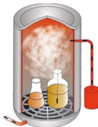
Production de vapeur via un générateur intégré
